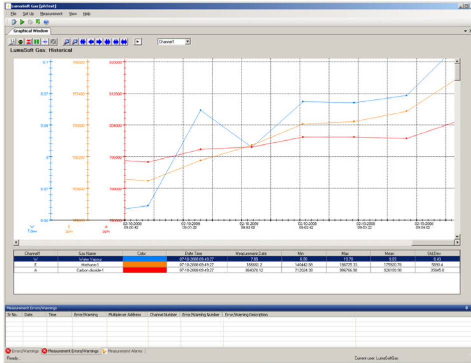
图3：曲线数据窗口。在同一坐标系中可以同时显示最多7条曲线。用户可选择数据点类型，坐标比例，曲线的类型和颜色，图形窗口背景的类型及颜色。
